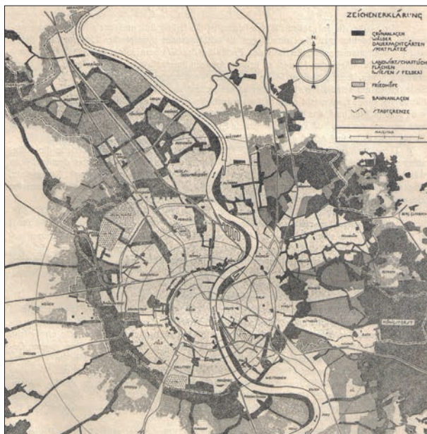
Schumachers Plan für das Kölner Grünsystem (1923) mit der Vernetzung grüner Korridore bis in die Innenstadt. Dies fördert den Artenreichtum, den Klimaschutz und die Luftqualität
